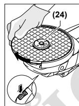
Натиснете бутона за фиксиране на вала (1), за да фиксирате вала за шлифоване. За да затегнете бързообтежната гайка, завъртете диска за шлифоване силно по посока на часовника.
