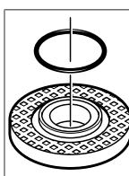
Около стъпалото за работния инструмент на центровация фланец (7) е поставен пръстен от изкуствен материал (О-пръстен). **Ако О-пръстенът липсва или е повреден**, трябва задължително да поставите нов центровещ фланец (7).
