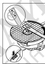
Правилно затегната и изправна гайка за бързо затягане можете да развиеете чрез завъртане на пръстена обратно на часовниковата стрелка. **В никакъв случай не опитвайте да развивате с клещи блокирана гайка, за целта използвайте ключ с два отвора.** Използвайте ключа с два отвора както е показано на фигуранта.
