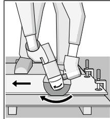
Електроинструментът трябва да се води винаги подаване в обратна посока. В противен случай съществува опасност той да бъде изхвърлен неконтролируемо от среза. При рязане на профили и четириъълни тръби най-добре използвайте минималното напречно сечение.
