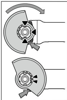
Поставете предпазния кожух (9) на захващащото стъпало на електроинструмента така, че кодиращите гърбици да съвпадат с каналите на стъпалото. При това натиснете и задръжте освобождаващия лост (1).
