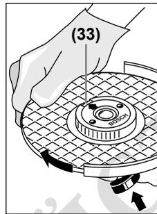
Натиснете бутона за фиксиране на вала (2), за да фиксирате вала за шлифоване. За да затегнете бързообтяжната гайка, завъртете диска за шлифоване силно по посока на часовника.
