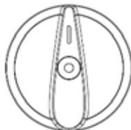
Завъртете превключвателя Off / Run / Choke на "0".
