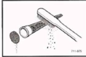
4. Проверете екрана на шумозаглушителя и на устройството за спиране на искри, заменете ги ако са повредени.
