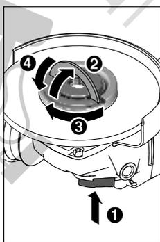
Натиснете бутона за фиксиране на вала (3), за да фиксирате вала за шлифване. За да затегнете бързообтяжната гайка (25), вдигнете скобата на бързообтяжната гайка и завъртете силно бързообтяжната гайка по часовника. Свалете скобата за фиксиране на бързообтяжната гайка. **Затягане по ръба на диска не е достатъчно.**
