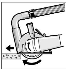
Включете електроинструмента и го поставете върху детайла с предната част на водещата шейна. Придвигвайте електроинструмента с умерено подаване, съобразено с обработвания материал.
