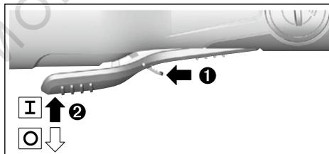
За **въвеждане в експлоатация** на електроинструмента избутайте лоста за отключване (13) напред и натиснете след това превключвателя за вкл/изкл (12) нагоре.
