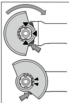
Поставете предпазния кожух (15) на захващачото стъпало на електроинструмента така, че кодиращите гърбици да съвпадат с каналите на стъпалото. При това натиснете и задръжте освобождаващия лост (1). Притиснете предпазния кожух (15) към шийката на електроинструмента, докато борта на предпазния кожух допре до фланеца на електроинструмента и завъртете предпазния кожух,
