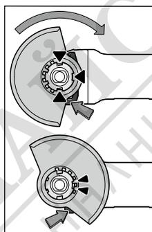
Поставете предпазния кожух (6) на захващачото съпало на електроинструмента така, че кодиращите гърбици да съвпадат с каналите на съпалото. При това натиснете и задръжте освобождаващия лост (1).
