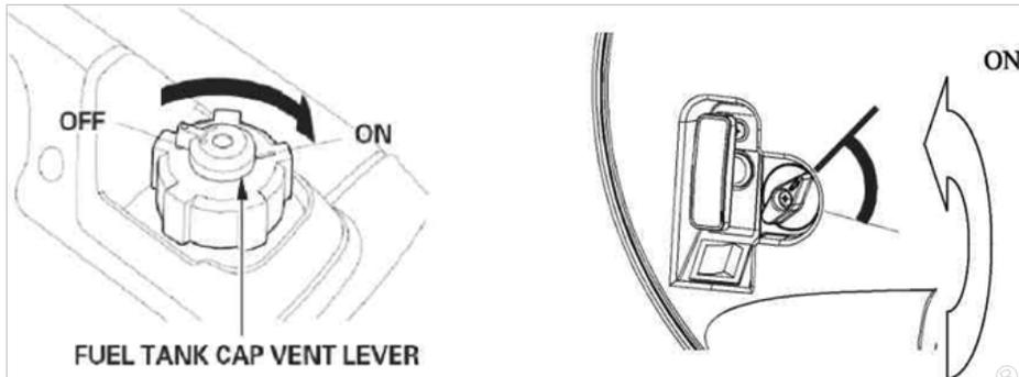
4.2. Завъртете ключа на двигателя в положение "ON".
