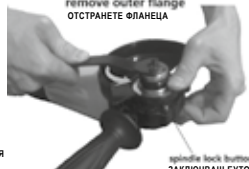
remove outer flange ОТСТРАНЕТЕ ФЛАНЕЦА
