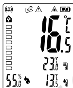
Разлика околна температура/ повърхностна температура: ≥ 6,5°C топлинен мост, дисплеят свети синьо и символът „△“ мига
