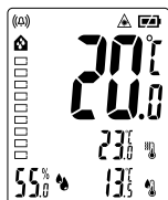
Разлика околна температура/ повърхностна температура: <3,5°C без топлинен мост
