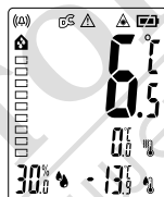
Разлика околна температура/ повърхностна температура: ≥ -6,5°C топлинен мост, дисплеят свети червено и символът „△“ мига
