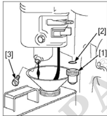
3. Развийте свещта и изсипете една лъжичка двигателно масло в цилиндъра. Леко издърпайте стартерното въже за да се завърти вала и да разнесе маслото по стените на цилиндъра. След това издърпайте въжето докато усетите съпротивление. Това ще затвори клапаните и ще защити от корозия. След като поставите свещта на ръка, я дозатегнете правилно с ключ.
