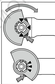
Поставете предпазния кожух (8) на захващачото стъпало на електроинструмента така, че кодиращите гърбици да съвпадат с каналите на стъпалото. При това натиснете и задръжте освобождаващия лост (1). Притиснете предпазния кожух (8) към шийката на електроинструмента, докато борта на предпазния кожух допре до фланеца на електроинструмента и завъртете предпазния кожух, докато чуете отчетливо прещракване.
