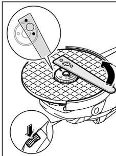
Правилно затегнатата и изправна гайка за бързо затягане можете да развийте чрез завъртане на пръстена обратно на часовниковата стрелка. **В никакъв случай не опитвайте да развийте с клещи блокирана гайка, за целта използвайте ключ с два отвора.** Използвайте ключ с два отвора както е показано на фигурата.
