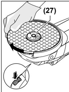
Натиснете бутона за фиксиране на вала (1), за да фиксирате вала за шлифване. За да затегнете бързообтяжната гайка, завъртете диска за шлифване силно по посока на часовника.
