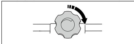
2. За да намалите ъгъла на ножа, завъртете бутона за регулиране на ножа обратно на часовниковата стрелка.
