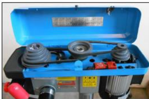
Фигура 31 – Секция на шайбите
