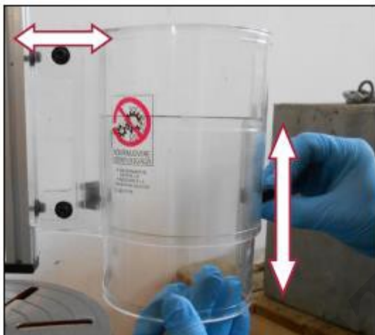
Фигура 41 – Участъци на плъзгане на предпазителя във вертикална и надлъжна посока
