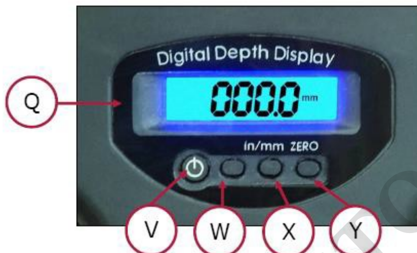
Фигура 29 – Дисплей за визуализация на спускането на патронника
