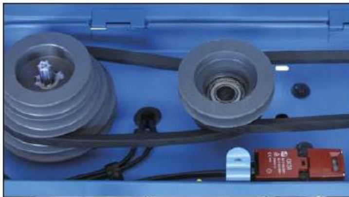
Фигура 34 – Преместване на шайбата
