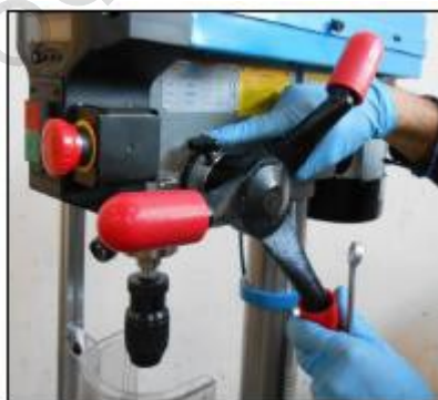
Фигура 36 – Винт за блокиране хода на патронника
