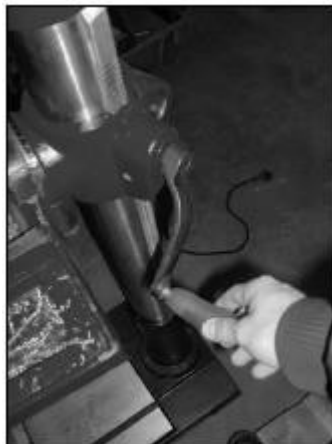
Фигура 39 – Регулиране на плота
