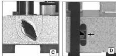
Разстоянието между водача и фрезера може да бъде прецизно настроено с винта (С) на скалата (D)
