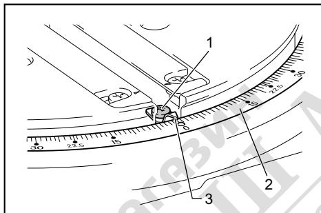
► 1. Screw 2. Miter scale 3. Pointer
