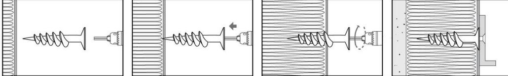
Su materiali isolanti non intonacati avvitare il tassello senza foratura di sgrosso, con avvitatrice a batteria oppure con cacciavite / On non-plastered insulation materials install the fixing, without pilot hole, using electric tool or screw driver.
