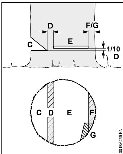
**Засекът (C)** определя посоката на поваляне
