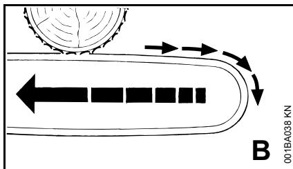
Когато при рязане с горната част на направляващата шина – заден врез – режещата верига се заклеши или опре на твърда повърхност в дървото, моторният трион може да занесе /скочи в посока на работещия с него – **за да избегнете това:**
