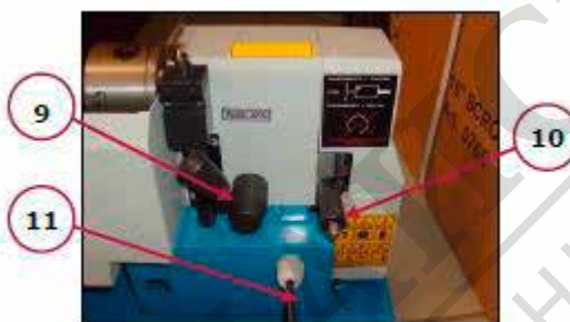
Фигура 2 – Основни части на струга с променлива скорост (каталожен номер 0716)
