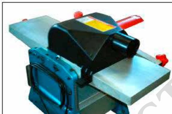
Фигура 25 – Колектор над работния плот
