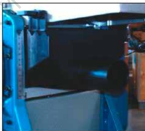
Фигура 20 – Правилно разположение на колектора под работния плот
