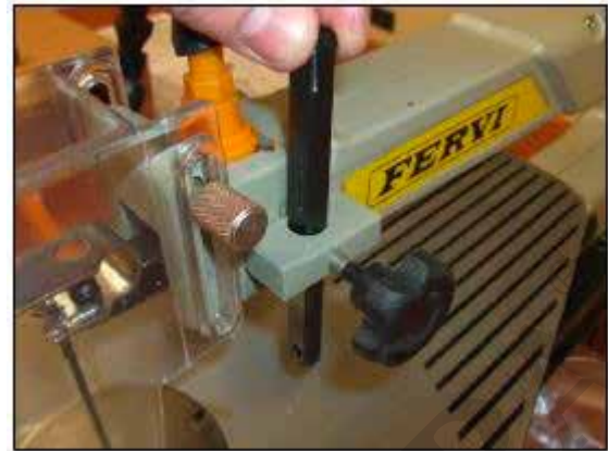
Фигура 9 – Монтаж на рейката за поддържане на вилката
