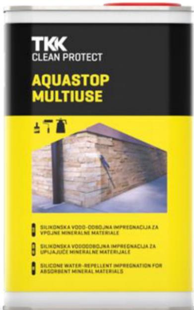
Aquastop Multiuse е безцветна течност на базата на силан-силоксани в органичен разтворител за окончателна защита на порести [абсорбиращи] неорганични материали срещу вода и влага. Поради високата си абсорбционна способност той прониква дълбоко в порите на материала и след като разтворителят се изпари, образува невидимо импрегниране на повърхността без образуване на филм.
