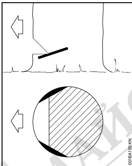
При дървета с наддължен фазер – нарезите предотвратяват разцепване на ствала при повалянето на дървото – те се нарязват от двете страни на ствала на височината на основата на засека на приблизително 1/10 от диаметъра на дървото, а при по-дебели дървета – на дълбочина най-много равна на широчината на шината.
