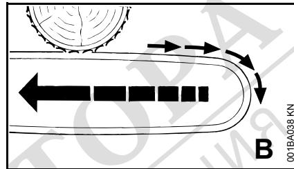
Когато при рязане с горната част на направляващата шина – заден врез – режещата верига се заклещи или опре на твърда повърхност в дървото, моторният трион може да занесе /скочи в посока на работещия с него – **за да избегнете това:**
