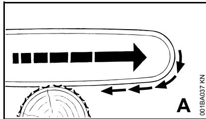
Когато при рязане с долната част на направляващата шина – преден врез – режещата верига се заклещи или опре на твърда повърхност в дървото, моторният трион може да занесе /скочи рязко в посока към ствала на дървото – **за да избегнете това, винаги забивайте здраво зъбната опора.**
