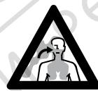
Моторният уред отделя отровни отработени газове, когато двигателят е в движение. Тези газове могат да бъдат без мириз и цвет и да съдържат неизгорели въглеводороди и бензол. Никога не работете с моторния уред в затворени или лошо проветрявани помещения – дори ако машината Ви е с катализатор.
