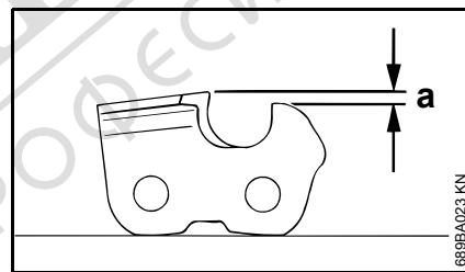
Ограничителят на дълбочината на рязане определя дълбочината на проникване на триона в дървото, а оттам и дебелината на стружката.
