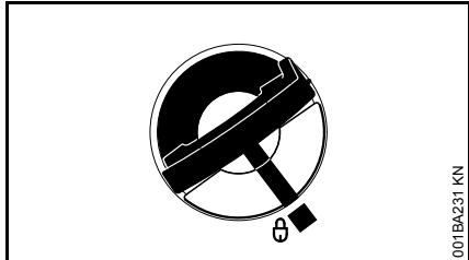
Тогава маркировките върху капачката на резервоара за гориво и резервоара за гориво се припокриват /съвпадат
