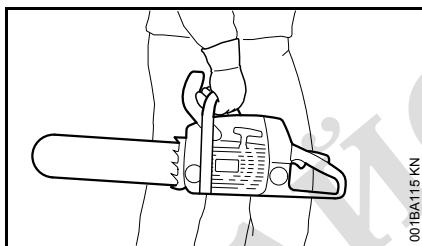
Моторният трион да се носи като се държи само за тръбната дръжка – горещия звукозаглушител далеч от тялото, направляващата шина назад. Не докосвайте нагорещените части на машината, особено горната повърхност на звукозаглушителя – опасност от изгаряне!
