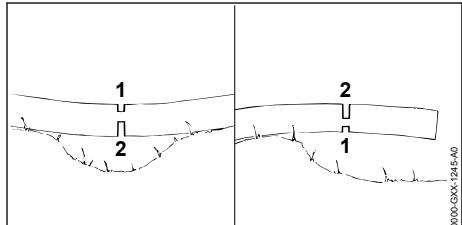
Когато се реже дървесина, намираща се под напрежение, направляващата шина може да се заклеши. Ползвателят може да изгуби контрол върху моторния трион и да получи сериозно нараняване.
